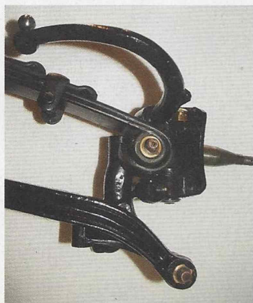
Oben Blattfeder, unten Querlenker: die Vorderradaufhängung des 301
