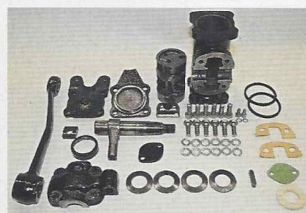
Überholen, nicht tauschen: Das Zerlegen der Stoßdämpfer ist kein Hexenwerk
