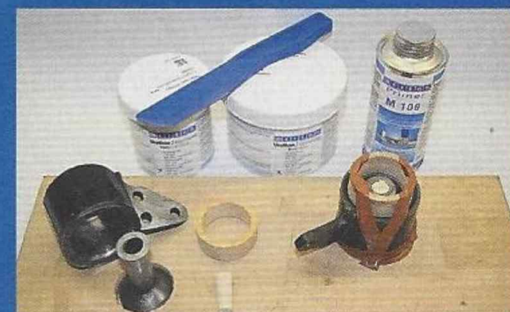
Marke Eigenbau: Die Lagerblöcke des Motors baute unser Schrauber selbst
