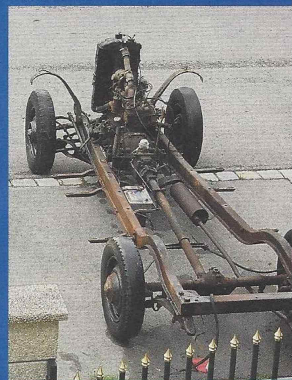
Simpel aufgebaut: das Chassis. Die Karosse ist binnen fünf Stunden runter
