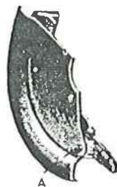
A : Méplat de réglage. La rotation du méplat A, dans le sens des aiguilles d'une montre, a pour effet de rapprocher les mâchoires du tambour.
