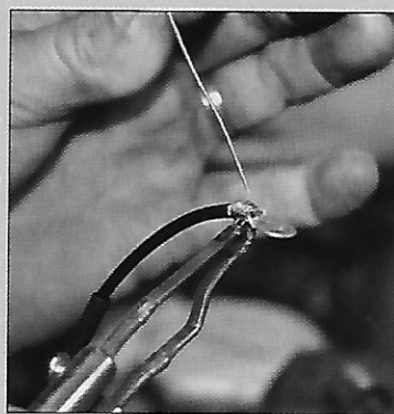
37 Equiper cette extrémité d'une gaine thermorétractable.
