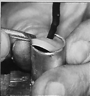
34 Mettre en place, derrière le sertissage, la rondelle d'étanchéité.
