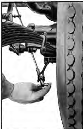
Fig. 16. — Réglage du frein arrière.
