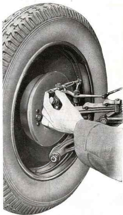
Fig. 20. — Réglage des freins avant.
