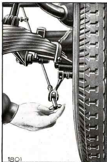
Fig. 21. — Réglage des freins arrière. de rodage.
