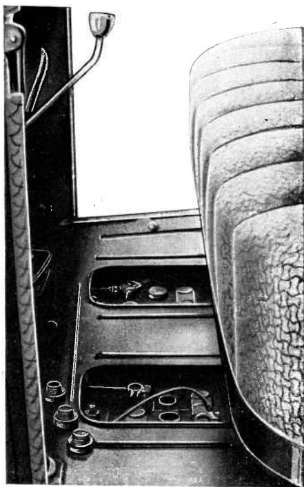
Fig. 29. — Vue montrant la facilité d'accès aux accumulateurs. On aperçoit sur le plancher les 3 bouchons démontés pour vérifier le niveau de l'électrolyte.
