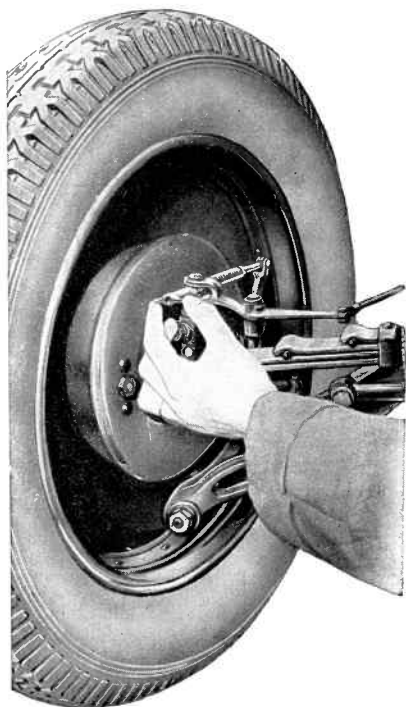
Fig. 22. - Réglage des freins avant.
