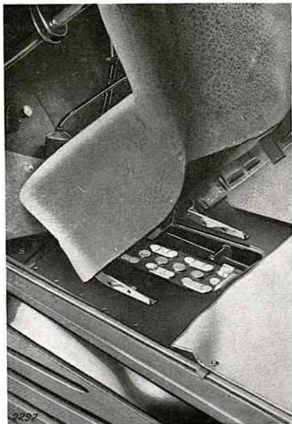
Fig. 28. — Accessibilité des accumulateurs.
