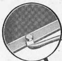
Fig. 32. — Fixation du câble de masse sur le châssis.
