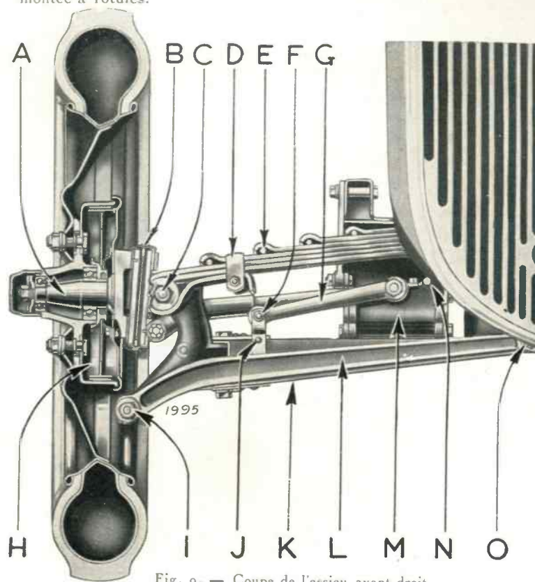
Fig. 9. — Coupe de l'essieu avant droit.
