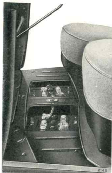
Fig. 54. — Vue montrant la facilité d'accès aux accumulateurs. On aperçoit sur le plancher les 5 bouchons démontés pour vérifier le niveau de l'électrolyte.
