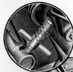
Fig. 19. — Écrou de réglage de la pédale de débrayage.
