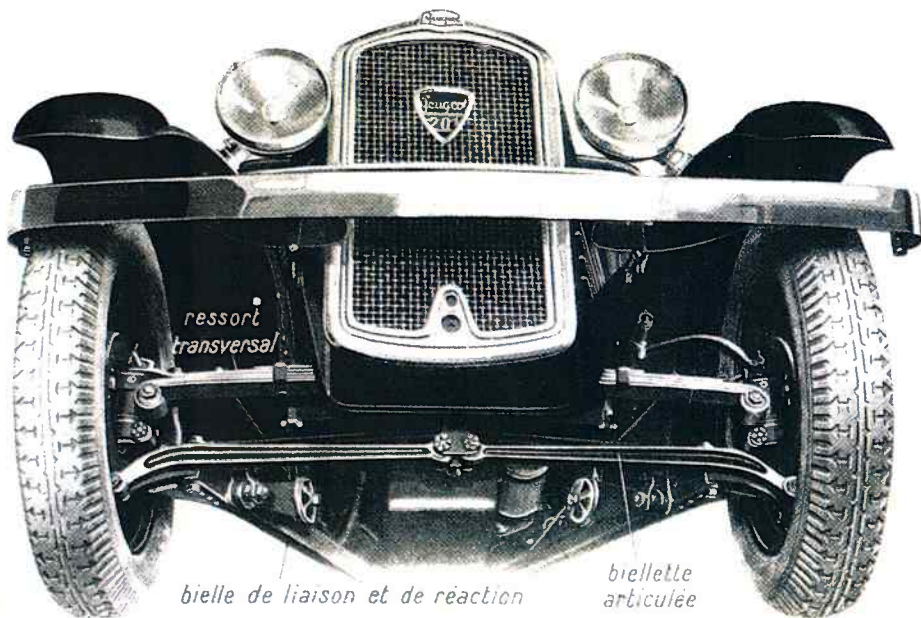
Principe de la suspension de la 201C.
