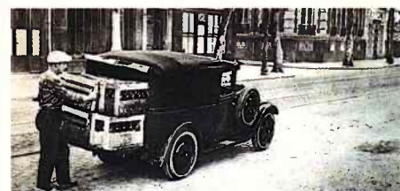
La "camionnette" sur châssis 201 dispose également d'une grande capote, complétée ici par des rideaux de côté.
